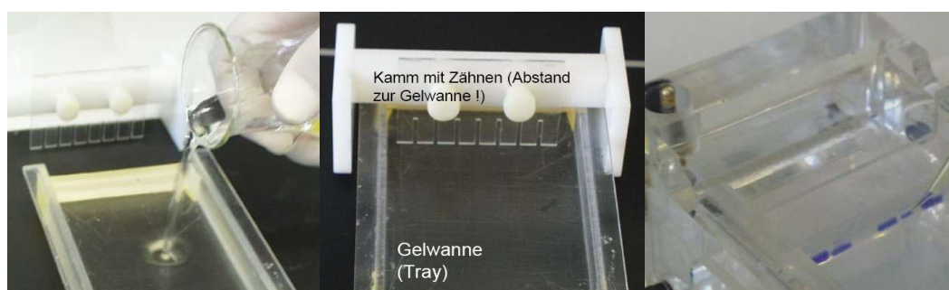
Abbildung 4: Aufbau der Gelkammer, Position des Kammes, Gießen und Beladen des Gels. Ein Kamm wird ca. 1 cm vor dem oberen Ende des Gels platziert (12 Probestaschen).
